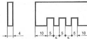
*Les chiffres de cote ne doivent pas être coupés par une ligne du dessin ou par un trait d'axe*
